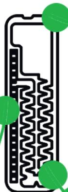
Скруглённые края и уменьшенная на 3,4мм длина эмиттера капельной ленты **Neo-Drip** исключает риск повреждения при укладке
