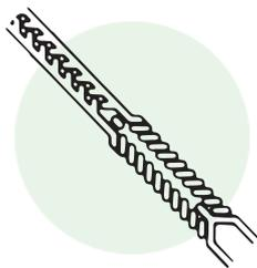
Щелевидная конструкция капельницы уменьшает риск повреждения насекомыми, препятствует проникновению корней и предотвращает блокирование внешними материалами капельниц. Усовершенствованная технология турбулентного потока воды обеспечивает равномерный расход при большей длине ленты.
